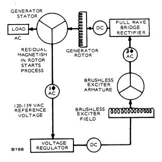
FIGURE 3. EXCITATION BLOCK DIAGRAM
