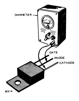
FIGURE 12. SCR RESISTANCE TEST
