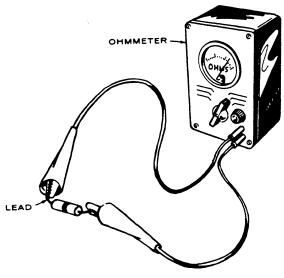
FIGURE 11. TESTING DIODES
