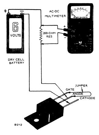
FIGURE 13. SCR VOLTAGE TEST
